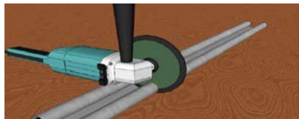
FB onteloventtiili voidaan lyhentää kulmaleikkurilla, metalliterää käyttäen.
