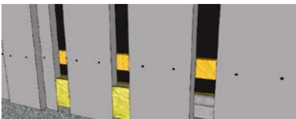
Pystylaudoituksen kaikki välit tiivistetään vuorivillalla tai muulla palonkestävällä tiivistysmateriaalilla.
