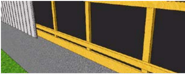
Seinä ennen FB onteloventtiilin asennusta
